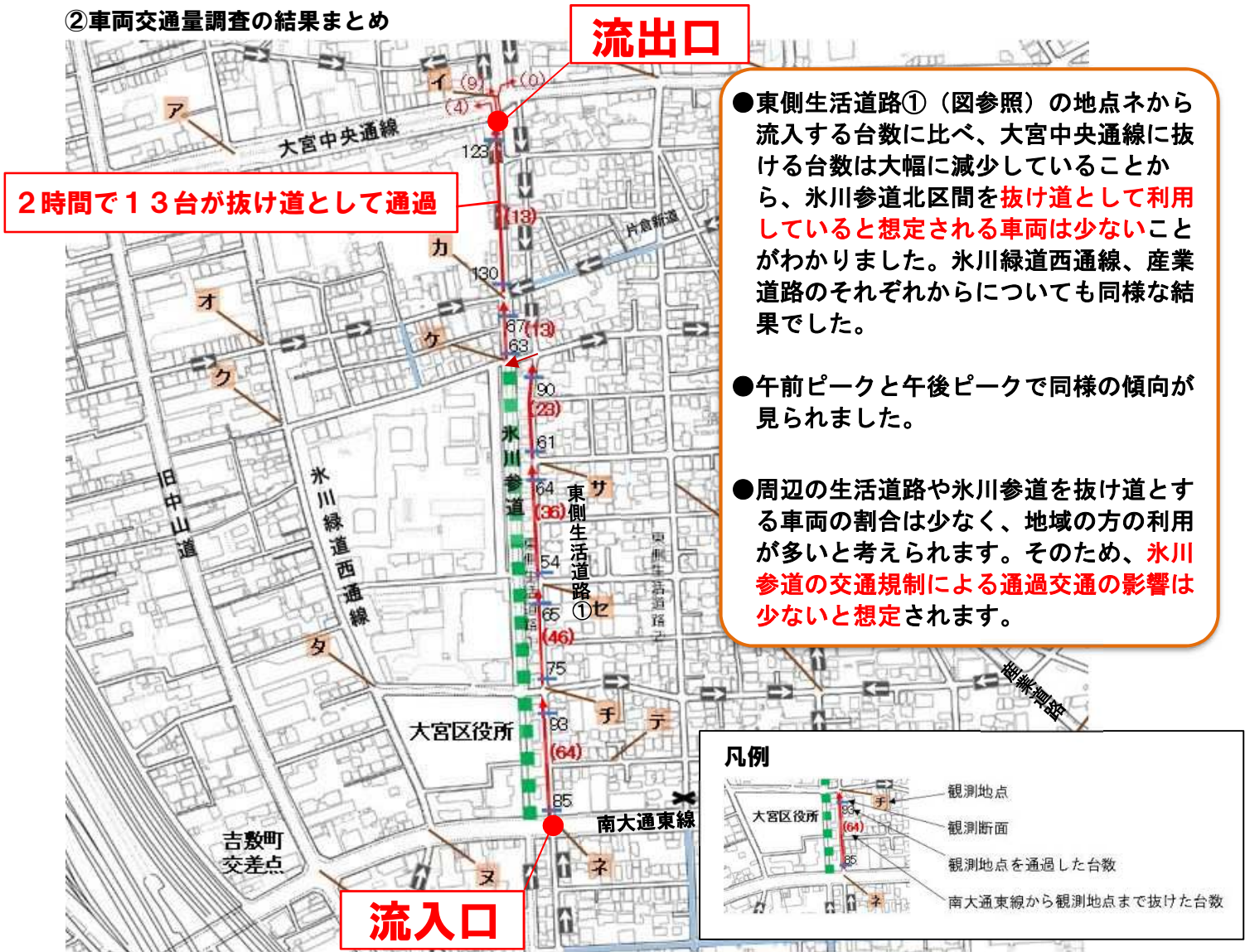
図【結果抜粋】東側生活道路①から流入し大宮中央通線に抜ける台数（午前7：30～9：30）
