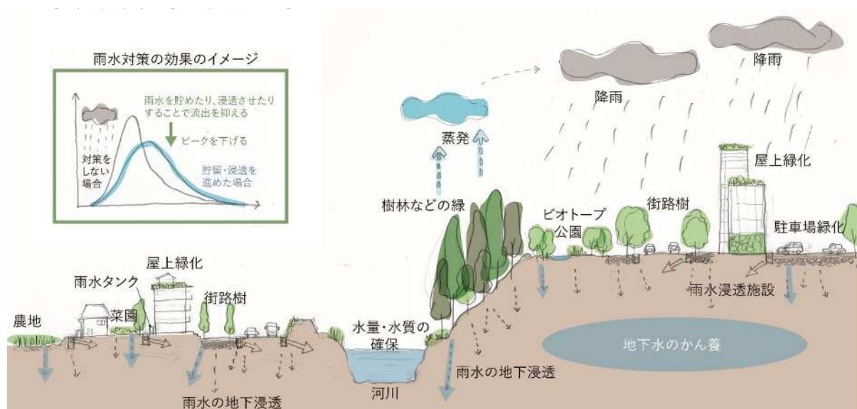
緑を生かした雨水の流出抑制のイメージ
