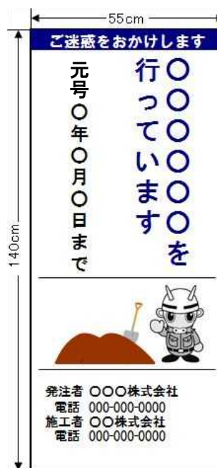
(様式4) 工事説明看板 (占用企業工事)
