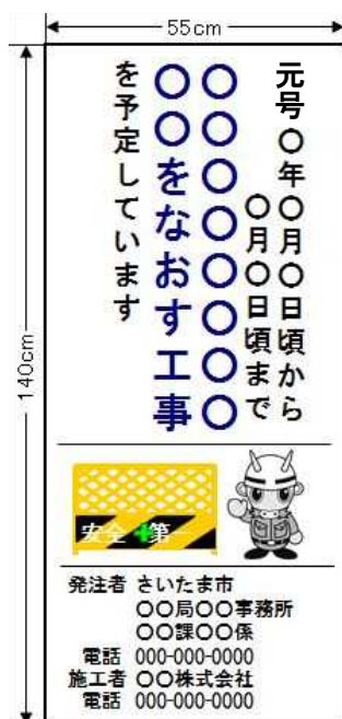
(様式1) 工事情報看板 (道路補修工事)
