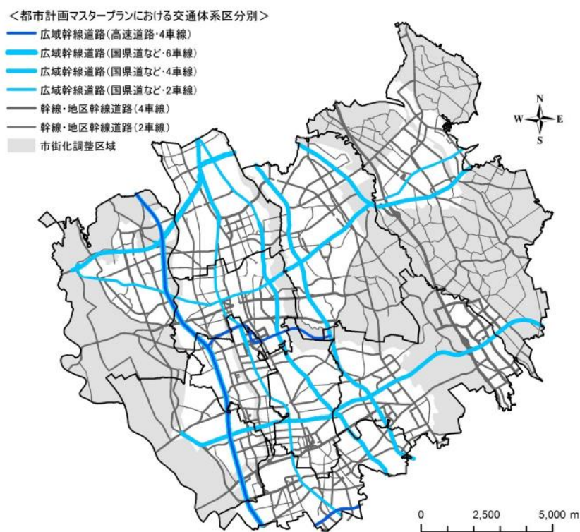
図 3-12 都市計画マスタープランにおける交通体系区分別道路ネットワーク図 資料：道路計画課資料（平成 30 年度さいたま市都市計画道路管理台帳等更新業務報告書）
