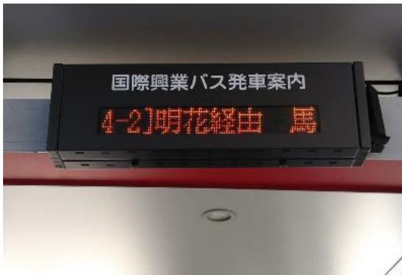
図 3-46 浦和駅東口に設置された吊り下げ式のバス運行情報案内システム
