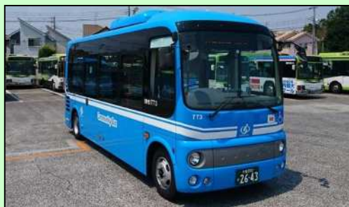
コミュニティバス（定員数 29～36 人※） ※定員数は例であり、運転手を含む人数
