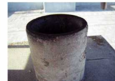
アスベスト含有煙突用断熱材（煙突）
