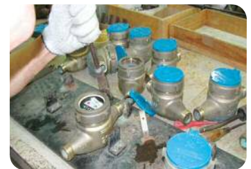
水道メーターの再資源化
