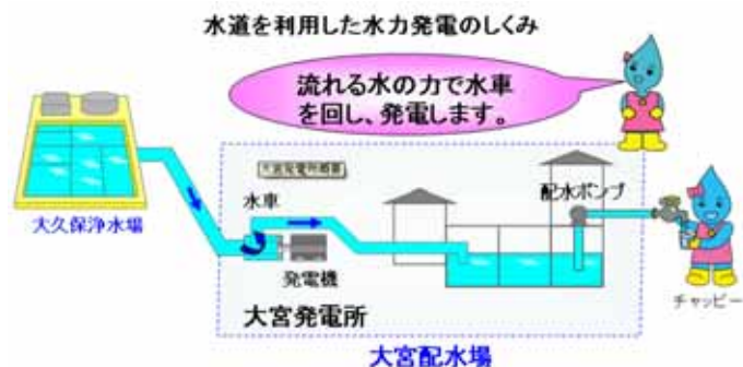
水道を利用した水力発電の仕組（大宮配水場）
