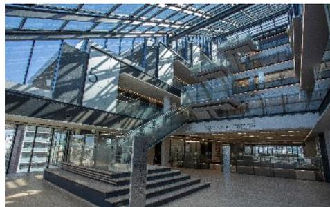
▲吹抜けの煙突効果を利用した自然換気の事例
